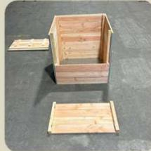
**4.** Assemblez la façade arrière aux façades latérales grâce aux platines de fixation.
