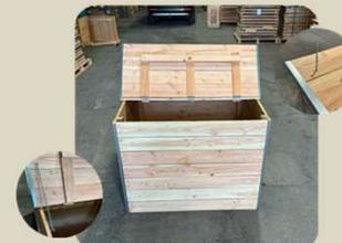
**6.** Vissez le couvercle à l'arrière du bac à l'aide des 2 vis fournies (1 par angles). Fixez la chaîne d'arrêt du couvercle, ou mettez une cale en bois à l'arrière de la première ouverture du capot
