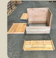
**3.** Assemblez la façade arrière à la façade de droite avec les platines de fixation.
