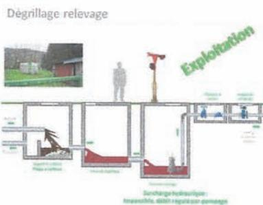
Pre-traitement des effluents: décantation primaire (pour soulager le proces) traitement (digestion) et stockage des boues primaires et secondaires
