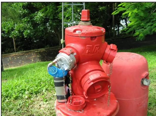
Figure 10 : Mesure de pression sur poteaux incendie
