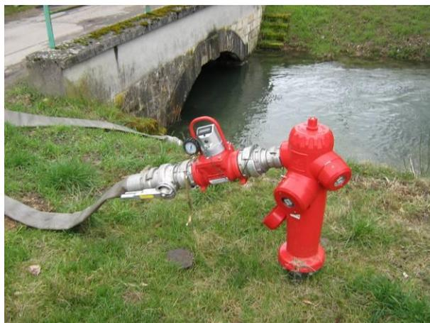
Figure 11 : Test sur poteau incendie (mesure du couple débit/pression)
